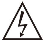
**Błyskawica zakończona strzałką umieszczona w trójkącie równobocznym ma za zadanie poinformować użytkownika o niebezpiecznym nieizolowanym napięciu występującym w produkcie, które niesie ryzyko porażenia prądem.**
