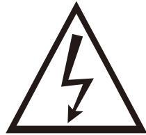
**Urządzenie działa pod wysokim napięciem. Aby zminimalizować ryzyko porażenia prądem, nie otwieraj obudowy, a naprawy zlecaj jedynie wykwalifikowanemu personelowi.**
