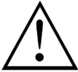
Signo de exclamación dentro de un triángulo equilátero indica información especialmente relevante para el usuario y contenida en la documentación adjunta al dispositivo.
