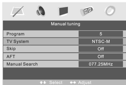
Klawiszami **[▲]** i **[▼]** wybierz odpowiednią zakładkę (PROGRAM, SYSTEM TV, POMIŃ, AUTO, DOSTRAJANIE, WYSZUKIWANIE RĘCZNE), a klawiszami **[▶]** i **[◀]** wyreguluj ustawienia. Ustawienia zatwierdzamy klawiszem **[MENU]**, wychodzimy wciskając **[EXIT]**.
