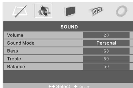
Um die Einstellungen zu hervorrufen, betätigen Sie die **[MENU]**-Taste der Fernbedienung bzw. am LCD-Monitor. Betätigen Sie erneut die **[MENU]**-Taste, und gehen Sie mit der Taste [**▶**] zu den AUDIO-Einstellungen über.
