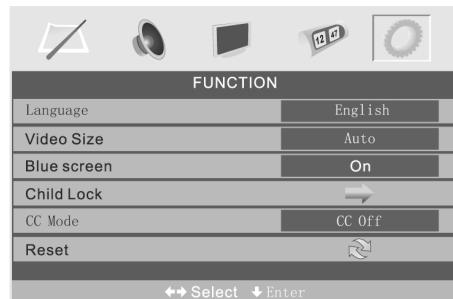
Wählen Sie mit den Tasten [▲] und [▼] die entsprechende Option (SPRACHE, ANZEIGENGRÖSSE, BLAUER BILDSCHIRM, SPERRE, CC-MODUS, RESET) und justieren Sie die Einstellungen mittels den Tasten [▶] und [◀]. Die Einstellungen werden mit der [MENU]-Taste bestätigt, zum Verlassen des Menüs [EXIT]-Taste betätigen.
