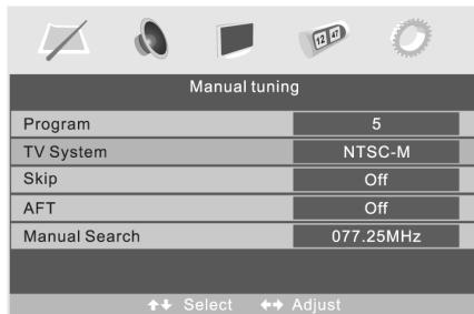
Клавишами **[▲]** и **[▼]** выберите соответствующую закладку (ПРОГРАММА, СИСТЕМА ТВ, ПРОПУСК, АВТО. ТОЧНАЯ НАСТРОЙКА, ПОИСК РУЧНОЙ), а клавишами **[▶]** и **[◀]** отрегулируйте настройки. Настройки мы утвердим клавишию **[МЕНЮ]**, выходим нажимая **[EXIT]**.
