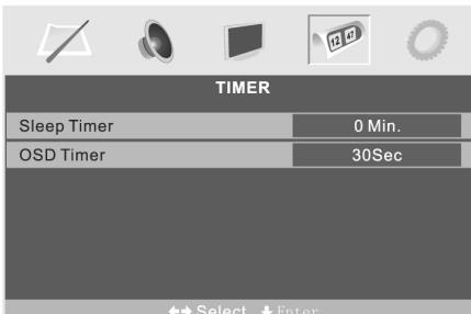
Wählen Sie mit den Tasten [▲] und [▼] die entsprechende Option (STANDBY-ZEIT, OSD-EINBLENDEZEIT) und justieren Sie die Einstellungen mittels den Tasten [▶] und [◀]. Die Einstellungen werden mit der [MENU]-Taste bestätigt, zum Verlassen des Menüs [EXIT]-Taste betätigen.
