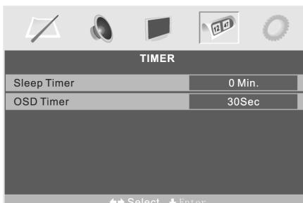
Pomocí klávesů [**▲**] a [**▼**] vyberte příslušnou záložku (ČAS AUTOMATICKÉHO VYPNUTÍ, ČAS ZOBRAZOVÁNÍ OSD), a klávesy [**▶**] a [**◀**] vyregulujte nastavení. Nastavené parametry potvrďte klávesem [MENU], návrat zpět pomocí tlačítka [EXIT].
