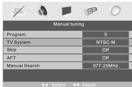
Wählen Sie mit den Tasten [▲] und [▼] die entsprechende Option (PROGRAM, TV-SYSTEM, ÜBERGEHEN, AUTO-ABSTIMMUNG, HANDSUCHLAUF) und justieren Sie die Einstellungen mittels den Tasten [▶] und [◀]. Die Einstellungen werden mit der [MENU]-Taste bestätigt, zum Verlassen des Menüs [EXIT]-Taste betätigen.
