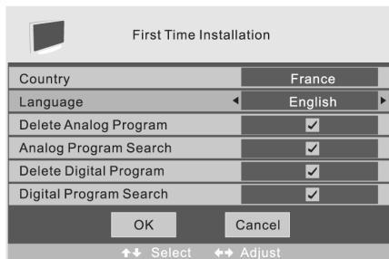
Клавишами [**▲**], [**▼**], [**▶**], [**◀**] выберите соответствующую закладку (СТРАНА, ЯЗЫК, УДАЛИТЕ ПРОГРАММУ, ИЩИТЕ ПРОГРАММУ, УДАЛИТЕ ЦИФРОВУЮ ПРОГРАММУ, ИЩИТЕ ЦИФРОВУЮ ПРОГРАММУ), установите и подтвердите настройки клавишей ОК.
