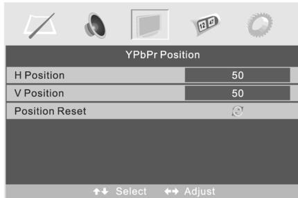
Pomocí klávesů [**▲**] a [**▼**] vyberte příslušnou záložku (HORIZONTÁLNÍ POZICE, VERTIKÁLNÍ POZICE, RESET POZIC), a klávesy [**▶**] a [**◀**] vyregulujte nastavení. Nastavené parametry potvrďte klávesem [MENU], návrat zpět pomocí tlačítka [EXIT].
