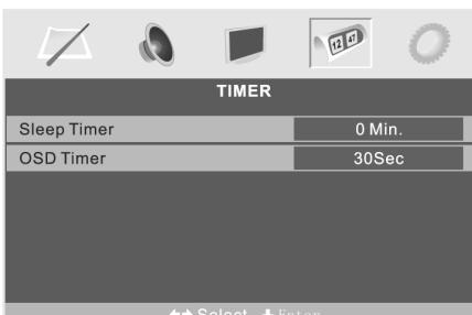
Клавишами [▲] и [▼] выберите соответствующую закладку (ВРЕМЯ ПЕРЕХОДА В СПЯЩИЙ РЕЖИМ, ВРЕМЯ ОТОБРАЖЕНИЯ OSD), а клавишами [▶] и [◀] отрегулируйте настройки. Настройки мы утвердим клавишью [МЕНЮ], выходим нажимая [EXIT].
