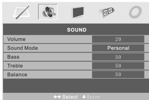
Aby wejść w ustawienia, należy wcisnąć klawisz **[MENU]** na pilocie lub na panelu LCD. Wciśnij ponownie klawisz **[MENU]** i przeskocz klawiszem **[▶]** do ustawień AUDIO.
