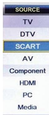
Mit den Tasten CH+/- oder ▲/▼ Eingangssignalquelle wählen.
