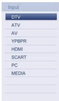
Stisknutím tlačítka **SOURCE** se na obrazovce zobrazí seznam dostupných zdrojů signálů. Tlačítka ▲/▼ zvolte zdroj, signál kterého chcete přijímat. Zvolený zdroj signálu zapněte stisknutím tlačítka **ENTER**.
