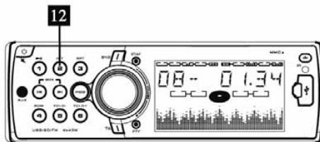
2. Podczas odtwarzania naciśnij przycisk „2 INT” i jeden z przycisków numerycznych (12), aby odtworzyć pierwsze 10 sekund z każdej ścieżki zapisanej na USB/karcie SD. Na ekranie zostanie wyświetlony numer ścieżki i czas przebiegu (zob. rysunek), co oznacza, że funkcja INT jest aktywna.
